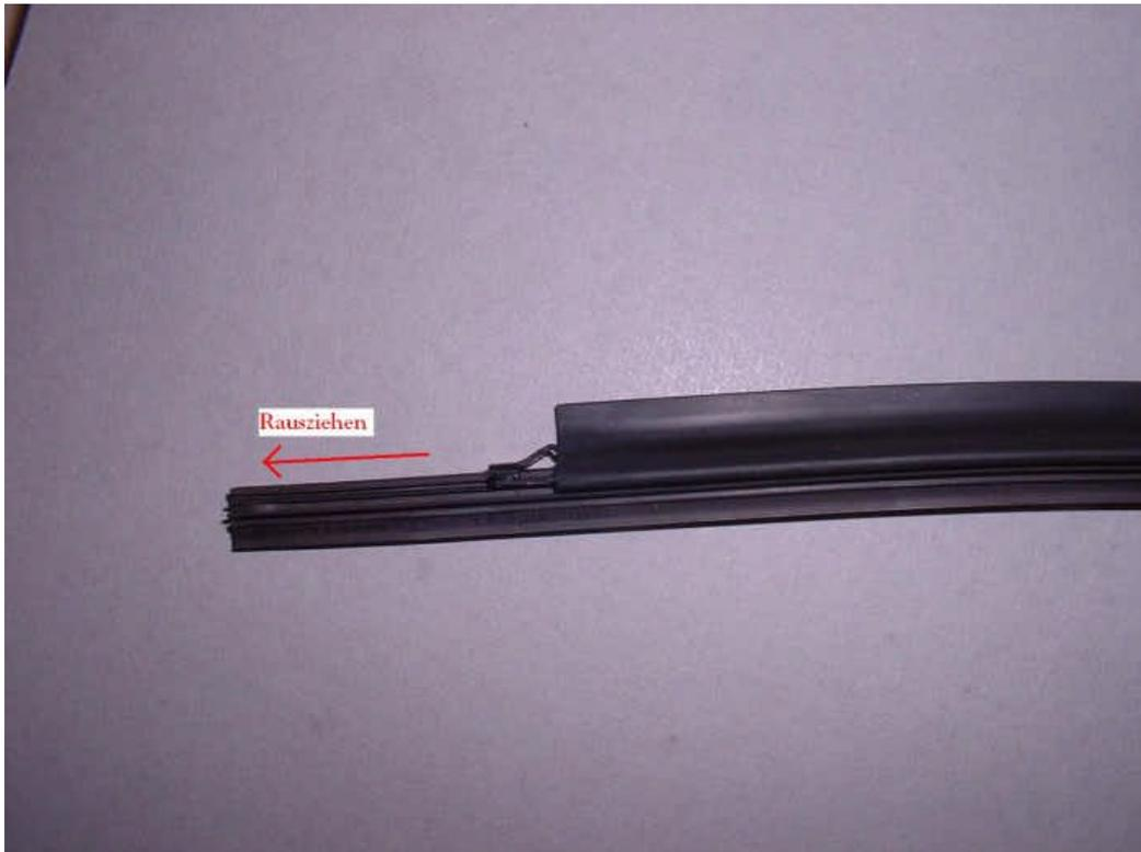
Den neuen Wischergummi auf die gleiche Länge abschneiden und reinschieben.
