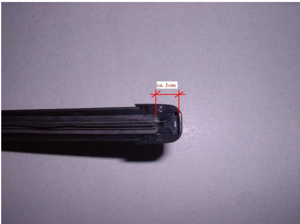
Sollte sich der neue Wischergummi nicht leicht einschieben lassen müsst ihr die jeweiligen Haltepunkte unten am Wischer links Mitte und rechts (Bild) mit einem Schraubendreher etwas aufbiegen.
