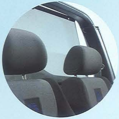
Statt Schal und Mütze: Das Windschott verhindert zu starke Luftverwirbelungen bei schneller Fahrt.
